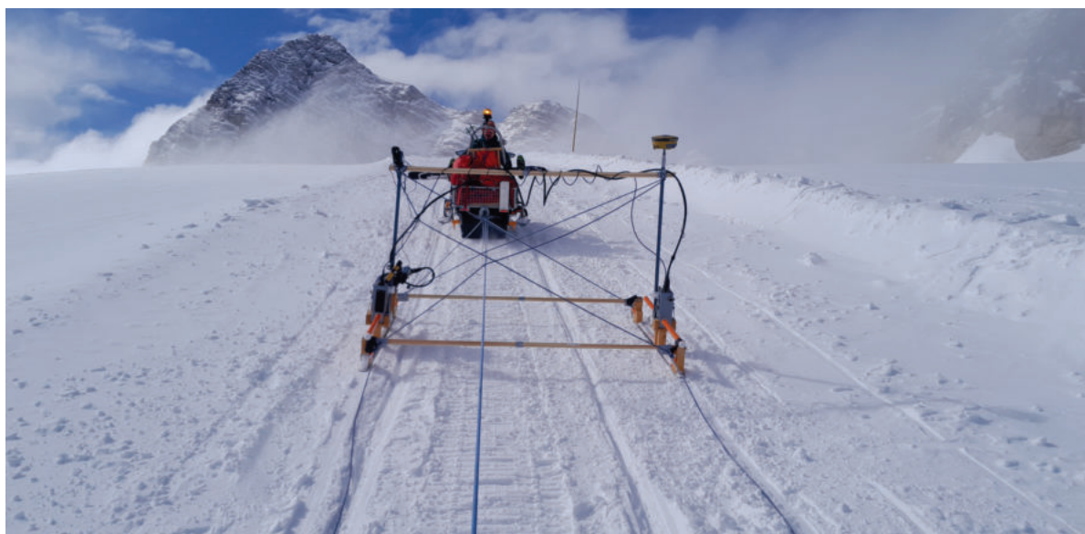
Abbildung 4.7: Messungen der Eisdicke mittels Bodenradar am 28. März 2025. Foto: Martin Stocker-Waldhuber
