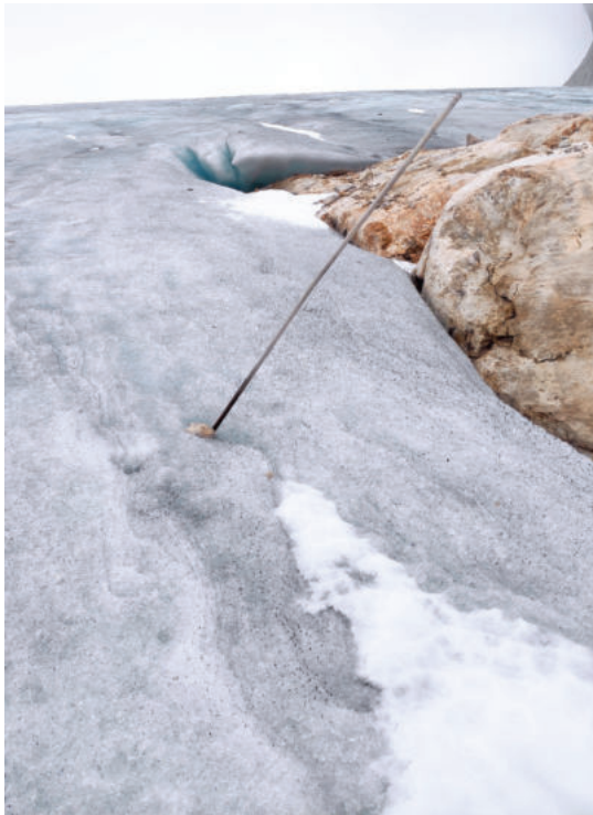
Abbildung A.21: Vergleich der Situation am Pegel 30 am 15. Juli 2025 (links) und 14. August 2025 (rechts). Zwischen den Begehungen aperte das Gestein so weit aus, dass der Pegel in den daraus entstandenen Hohlraum fiel. Fotos: G. Bertolotti.
